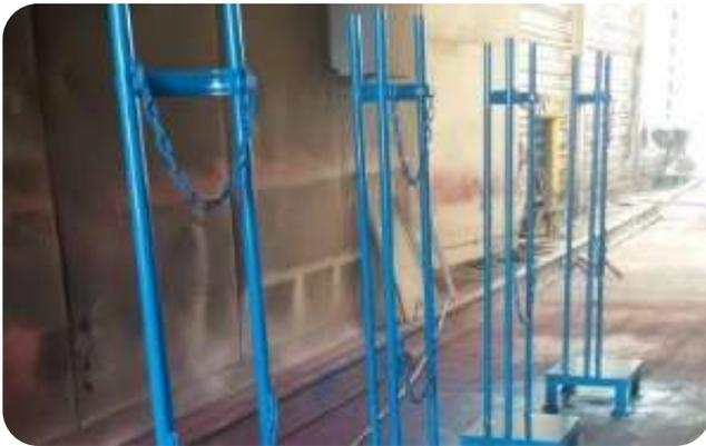
Fabricación de soportes de fijación para cilindros de argón.
